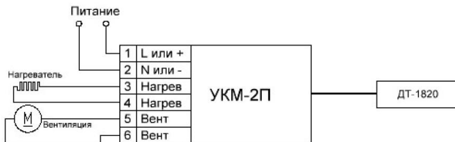
Рисунок П6.4. Типовая схема подключения.
