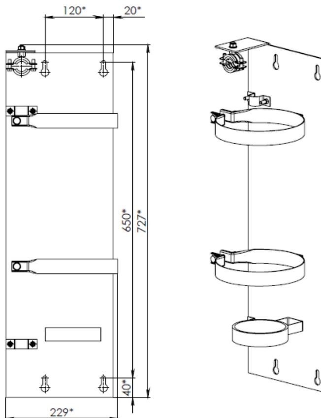
Рисунок А.9 – Кронштейн ФНПР.КРН.10-00.000 для крепления модуля с верхним расположением насадка
