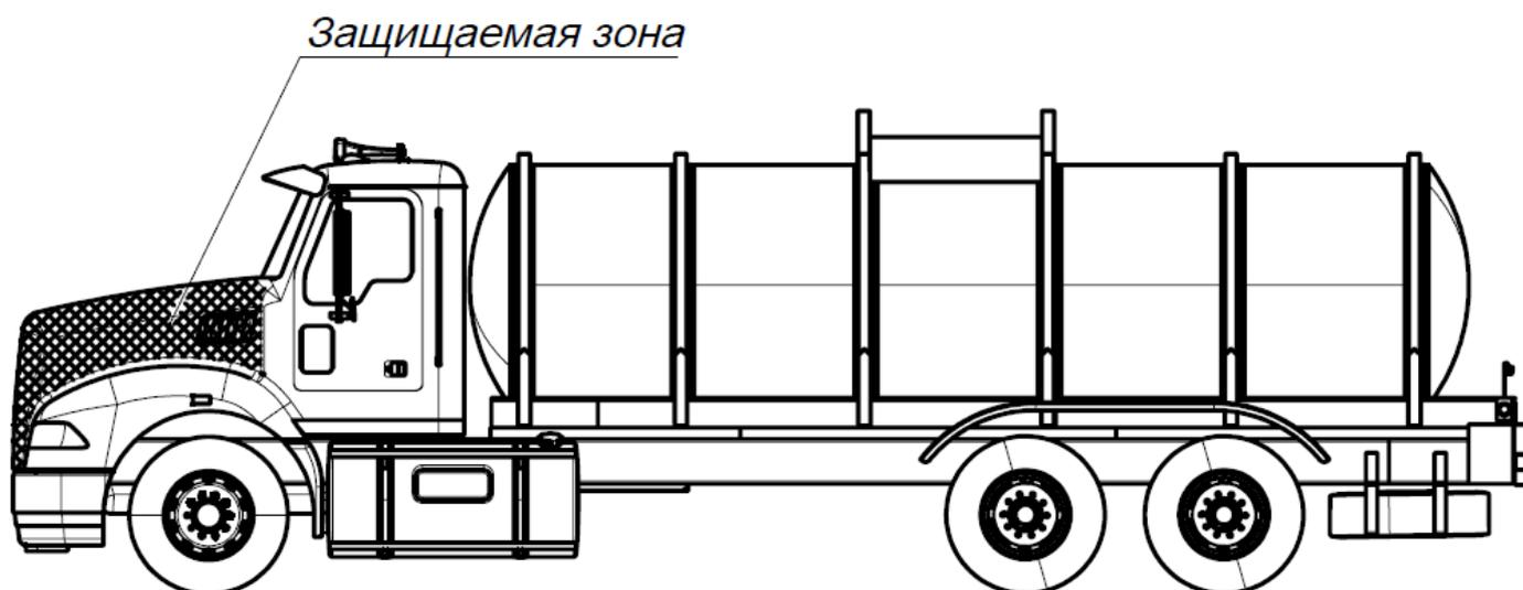
Рисунок Г.1 Зона пожаротушения
