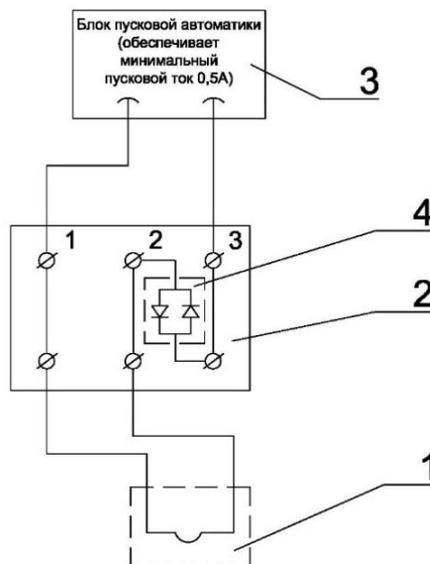
Рисунок 3 - Рекомендуемая схема подключения пусковой цепи.
