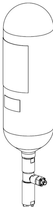
Рисунок А.4 – Модуль с одногорловым баллоном ФНПР.МГПП11.СХ1-00.00.000
