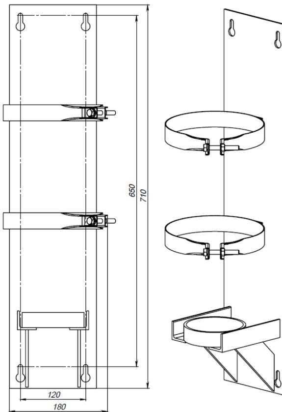
Рисунок А.8 - Кронштейн чертежа КЛЧ.КРН.10-00.000 для крепления модуля с нижним расположением насадка
