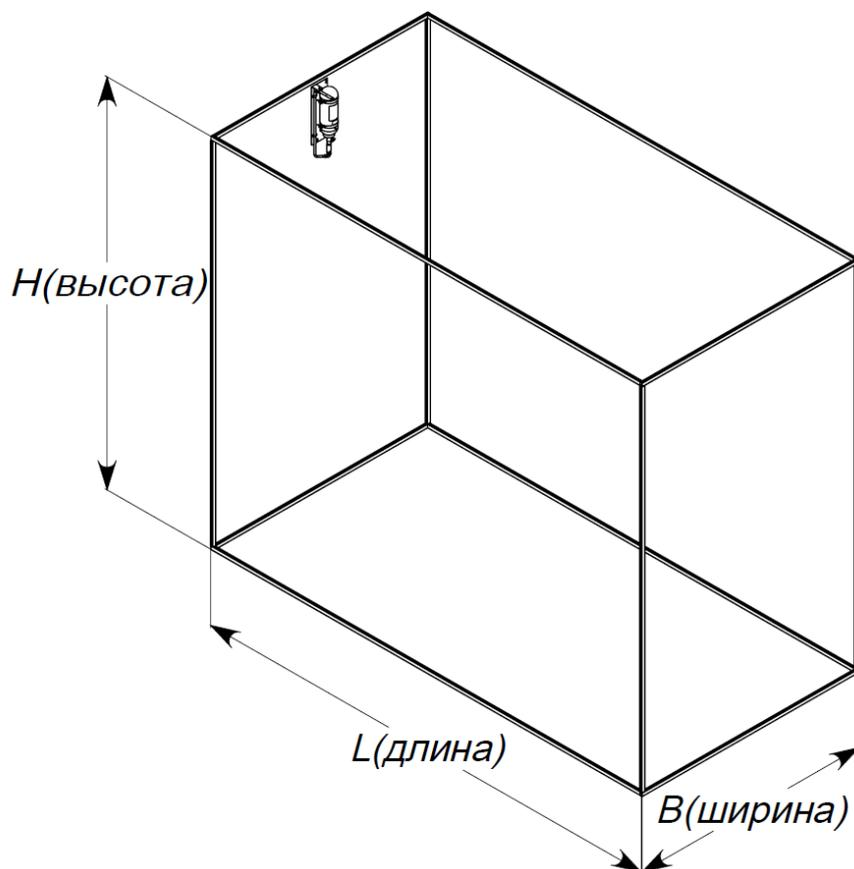
Рисунок А.1 - Схема распыления ГПОВ при объемном тушении
