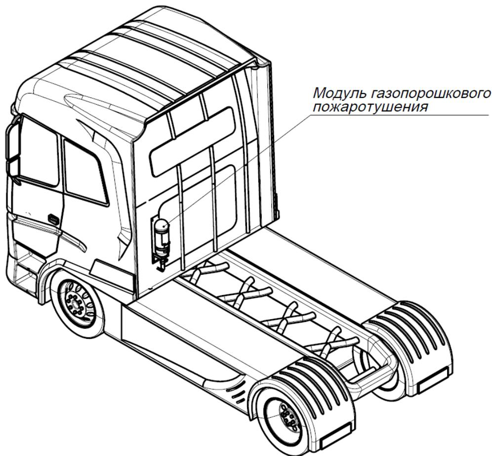
Рисунок Г.2 Схема установки системы для защиты подкапотного пространства
