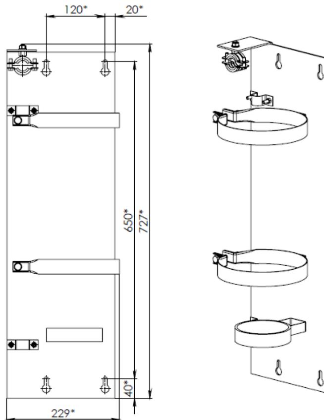
Рисунок А.9 – Кронштейн ФНПР.КРН.10-00.000 для крепления модуля с верхним расположением насадки
